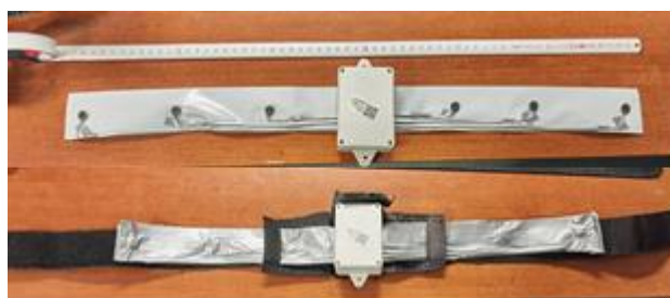
Slika 4 Zgodnji prototip haptičnega vmesnika za biomehansko povratno vezavo. Zgornja slika prikazuje razporeditev motorjev in povezavo s krmilno enoto. Spodnja pa predstavlja končen izgled, pripravljen za testiranje.
