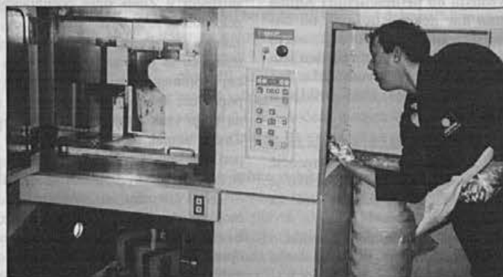
Komora za vakuumsko litje je ena glavnih naprav, s pomočjo katere dela Boris Mlakar
