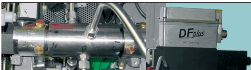
Slika 1. 4/3-proporcionalna potna ventila: a) na novo razviti vodni proporcionalni potni ventil (vodni preizkušalec), b) serijsko izdelani oljni proporcionalni potni ventil (oljni preizkušalec)
