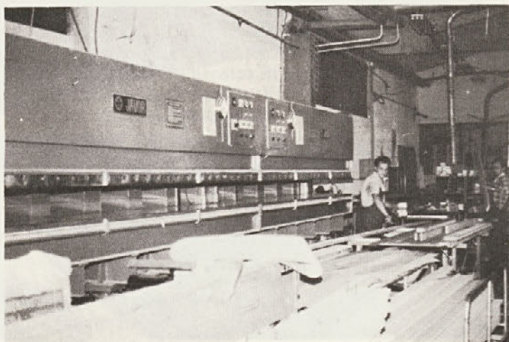
Hidravlična stiskalnica v TOZD LO (foto: Borsan).
