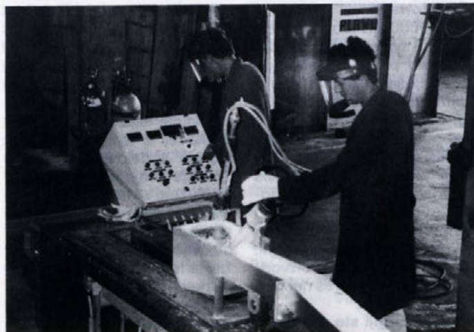
Poizkus na napravi za vertikalno ulivanje Titancinkove legure
