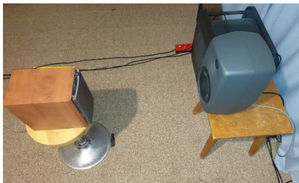
Slika 2. Fotografija postavitve v gluhi sobi na FE. Levo: merjeni zvočnik – mikrofoni; desno: Genelec zvočnika.
