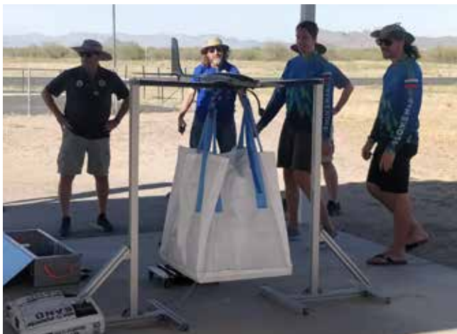
Slika 4 : Naloga na tleh - letalo vsaj 30 s zdrži obremenitev, ki je aplicirana v področju trupa.
