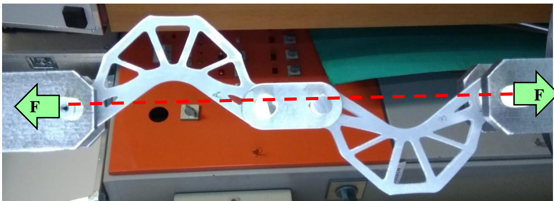
Slika 4: Preizkušanca oblike A in B na stroju za testiranje
