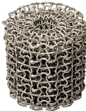
Slika 4: Preizkušavec novega osnosimetričnega celičnega avksetičnega metamateriala.
