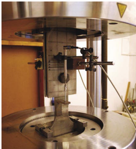
Slika 2 • Spoj M101 med testom (levo) in skica pozicij merilnikov pomikov LVDT (desno)
