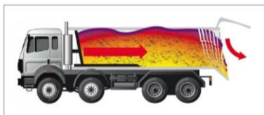
Slika 7: Ukrepi za preprečevanje temperaturne segregacije (Rošar, 2020)
