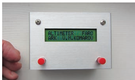
Podporna naprava omogoča enostavno odčitavanje višinomera in njegovo upravljanje
