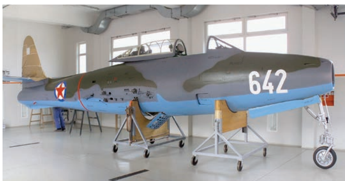
Po barvanju servisnih napisov je bilo treba na trupu opraviti še nekaj del na oznakah. Letalo so med obnavljanjem večkrat premikali iz delavnice v delavnico. Foto: Tomaž Perme
