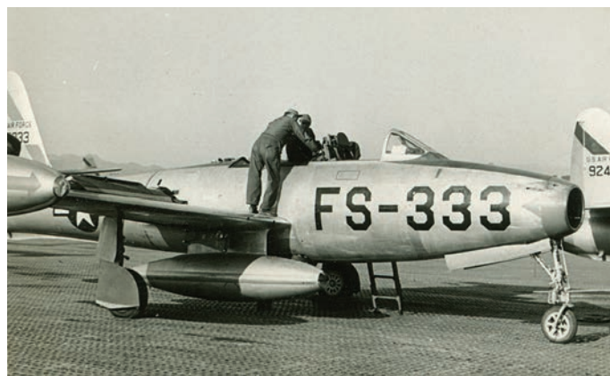
F-84E, 522. lovsko spremljevalne enote v Koreji leta 1951. Letalo je slikano še pred namestitvijo okrepljene kabine. Fotografirano je med rednim vzdrževanjem na prostem. Letalo ima pritrjene dodatne rezervoarje za gorivo na koncih kril in pod trupom, kamor so običajno obešali bombe.
