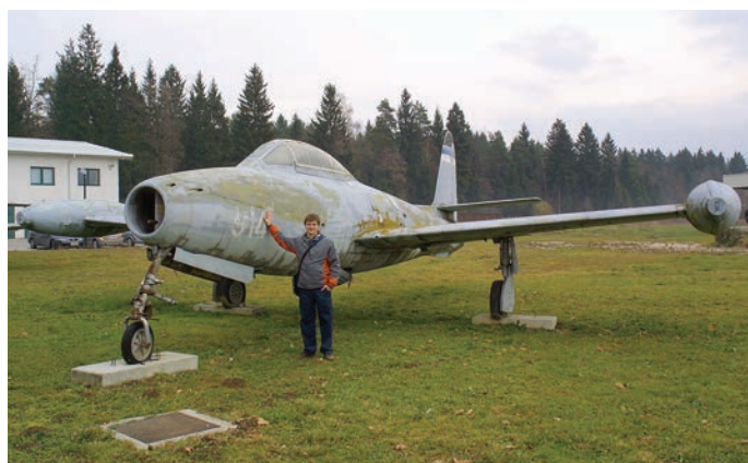
Kustos Vojaškega muzeja Slovenske vojske Matjaž Ravbar pozno jeseni leta 2007. Thunderjet je bil v času, ko je bil na letališču Brnik prebarvan in označen z napačno številko 914. Letalo kaže sledove grobega ravnanja med premiki po letališču (zvita prva noga podvozja) in atmosferskih vplivov, ki so ga dodobra zdelali. Foto: Tomaž Perme
