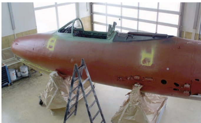
Thunderjet v delavnici Alojza Potočnika. Najprej se je obnavljal trup letala. Na sliki je že videti, kako je trup popravljen na mestih, kjer so bile vdrtine, in pobarvan s temeljno barvo. Foto: Tomaž Perme
