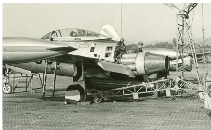
Letalo F-84E, slikano v Koreji leta 1951. Za lažje vzdrževanje in dostop do motorja so pri Republicu zadnji del letala skonstruirali tako, da ga je bilo mogoče hitro oddvojiti. To rešitev je pozneje povzel North American pri razvoju lovca F-86 sabre, pri nas pa tovarna Soko pri letalih galeb G-2 in jastreb J-21.
