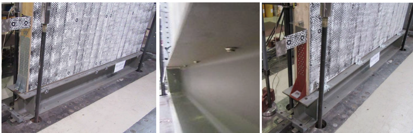
Slika 3 • Detalj pritrditve preskušancev z dvížnimi kotniki (levo) in vijaknimi spoji spodnje prečke okvirja preko pasnice jeklenega profila (sredina), vpetje panela B12-16/75x1/M z močnejšima dvížnim kotnikoma ob straneh in strižnimi kotniki na enakomernih razdaljah vzdolž ene strani panela (desno).
