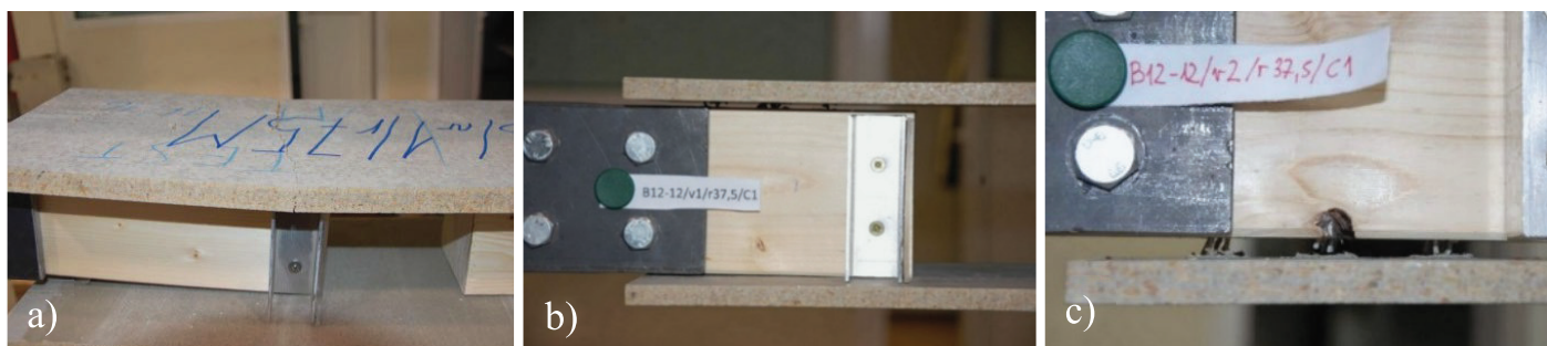
Slika 5 • Tipični porušni mehanizmi: a) porušitev plošče vzorca (B12-16/v1/r75/M); b) izvlek sponk (B12-12/v1/r37,5/C1); c) izvlek in pretrg sponk (B12-12/v2/r37,5/C1).
