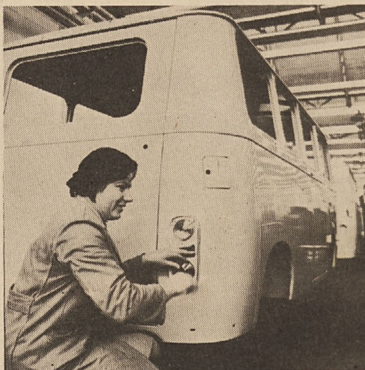
Vgrajevanje luči pri montaži
