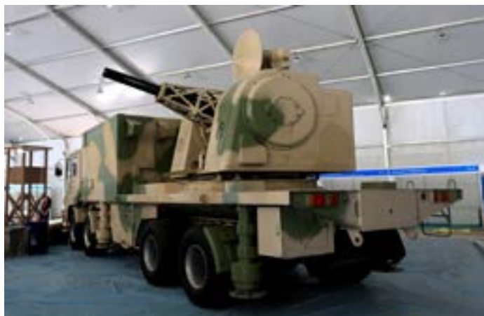
Slika 6: Kitajski sistem C-RAM LD-2000 (Vir: Kopp, 2014)
