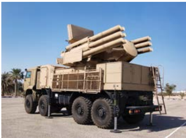
Slika 4: PANCIR S-1E oziroma 96K6 na vozilu MAN Cat SX 45 8 x 8 (Vir: KBP, 2016)
