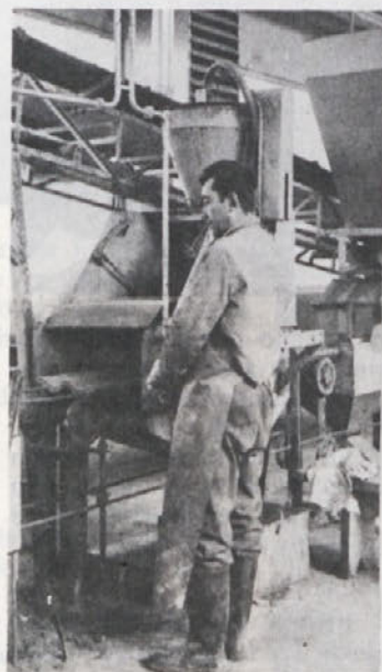
Vlaganje strešnikov na stojala, kjer se do konca posuše
