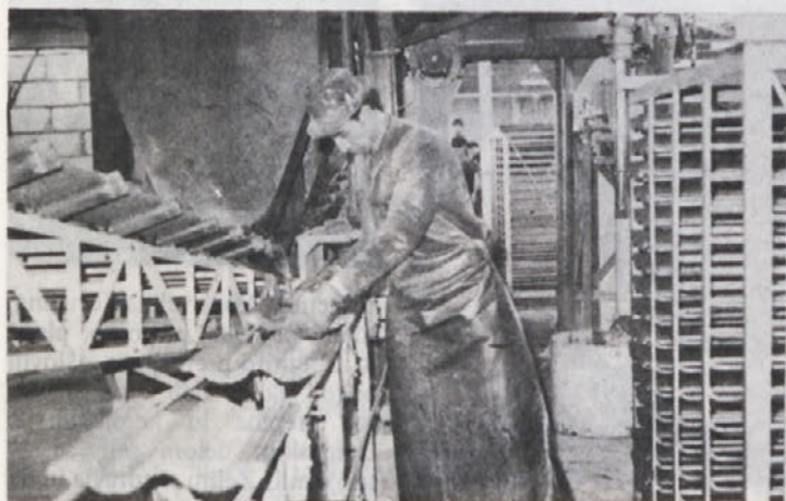
Tekoči trak za izdelavo strešnikov
