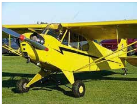
Šolsko visokokrilno letalo piper J-3 cub z motorjem 65 KM in dvema sedežema v tandem, s kakršnim je Lojze v New Yorku napravil prve pilotske korake.
