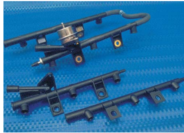
Vodi za vbrizgavanje goriva – odpornost na številna goriva za daljši čas do temperature 120 °C, odlične mehanske lastnosti (tlak do 10 bar) in samogasnost
