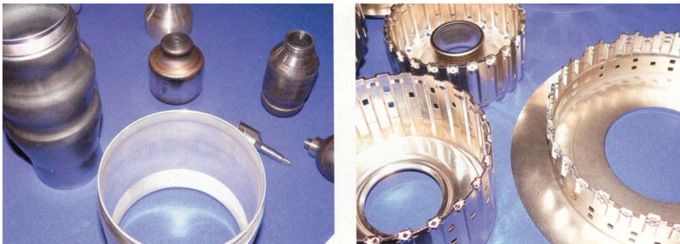
Notranji deli, izdelani po postopku rotacijskega preoblikovanja
