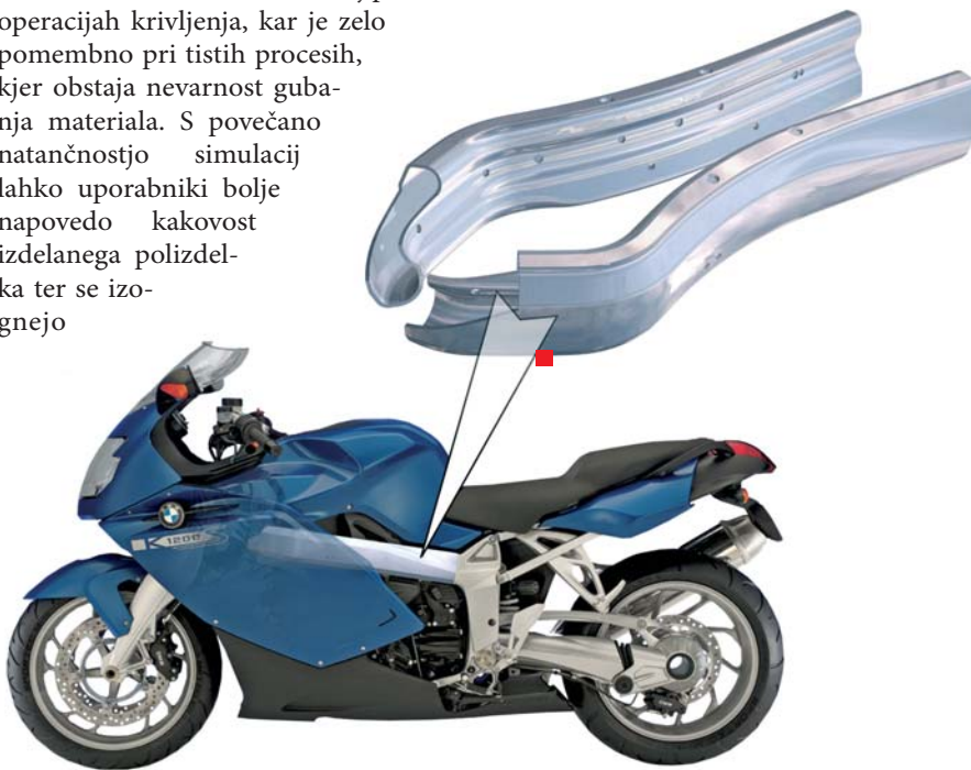
Simulacija dvodelne komponente okvirja v Autoformu
