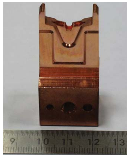
Ta bakrena elektroda je bila frezana v treh različnih položajih. Najmanjše orodje: D = 0,3 mm, R = 0,15 mm. Čas frezanja: 1 ura in 15 minut.
