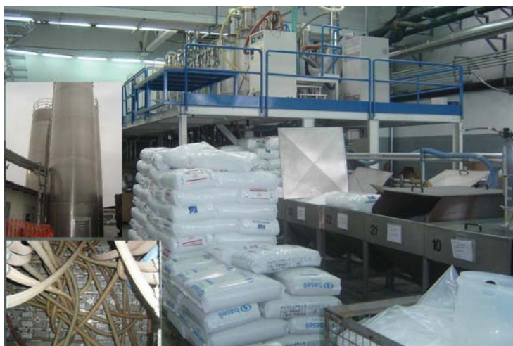
Slika 3: Sušenje materiala, skladiščenje v silosih in razdelilna postaja v podjetju LIV Plastika
