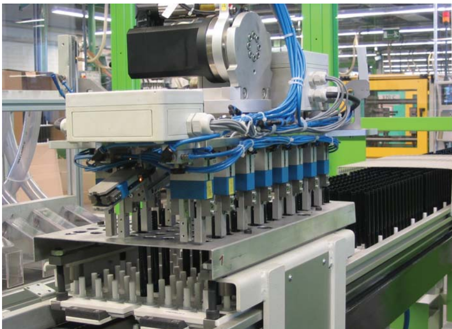
Stopnja 2. – nameščanje mehkih blazinic TPE na toge dele kemičnih in tehničnih svinčnikov ABS: v vsakem ciklusu glava robota ERC s 16 prijemali pobere osem kosov s pladnjem za vmesno shranjevanje (zgoraj), osem prostih prijemal pa odstrani končane izdelke z orodja, še preden varj vstavi nove za naslednji ciklus brizganja (desno).
