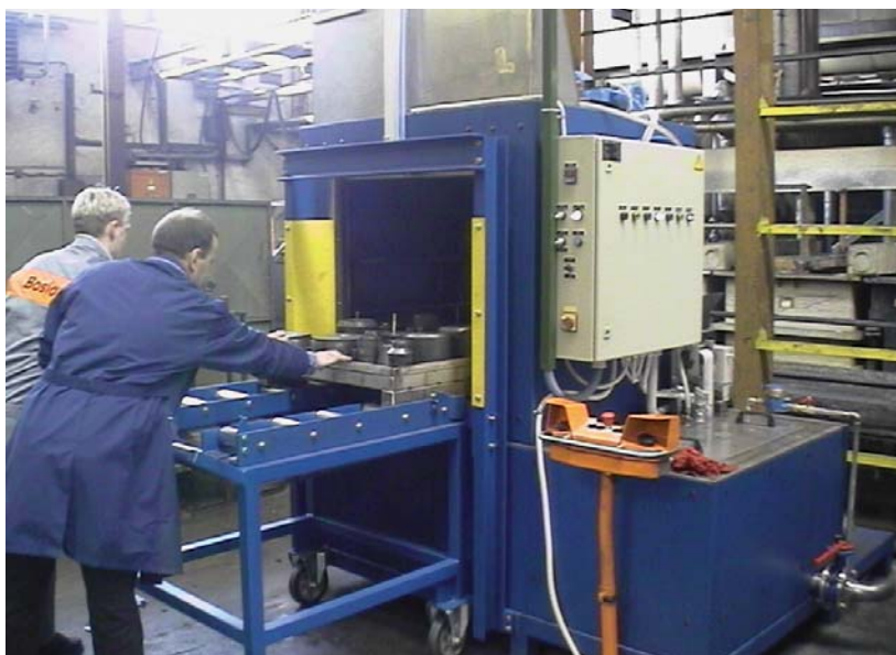
Komorni pralni stroj za pranje izdelkov po kaljenju ali po mehanski obdelavi
