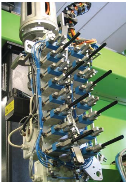
Stopnja 2. – nameščanje mehkih blazinic TPE na toge dele kemičnih in tehničnih svinčnikov ABS: v vsakem ciklusu glava robota ERC s 16 prijemali pobere osem kosov s pladnjem za vmesno shranjevanje (zgoraj), osem prostih prijemal pa odstrani končane izdelke z orodja, še preden varj vstavi nove za naslednji ciklus brizganja (desno).
