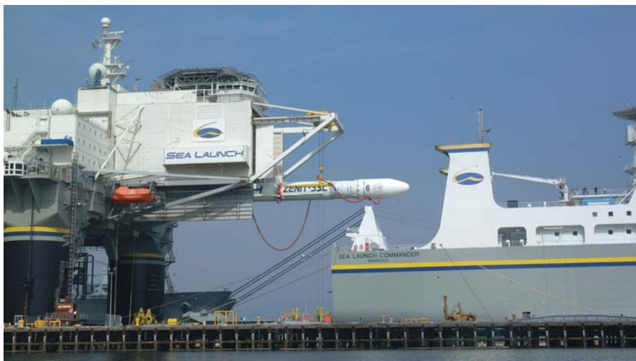
Pripravljeno nosilno raketo in tovor se preko dvigala, ki je na krovu, prenese z ladje na izstrelno ploščad.
