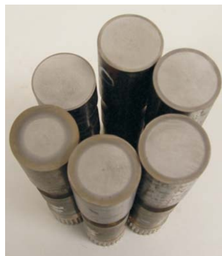
Slika 1: Različne globine cementacijske plasti
