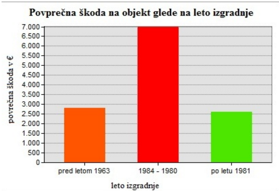
Slika 6: Graf povprečne škode glede na leto izgradnje stavb, zgrajene na pogojno primernih tleh (Šušteršič, 2012).
