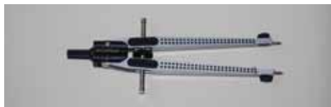
[Slika 4] Šestilo za risanje na pozitivno folijo
