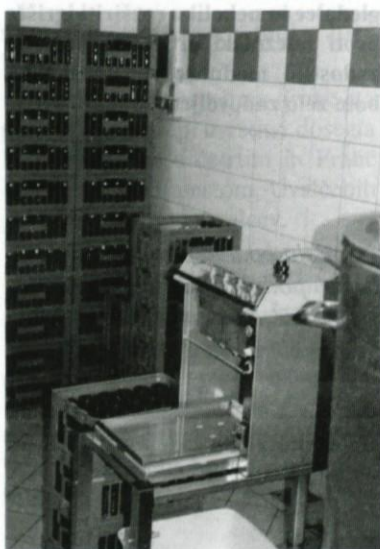
V POLNILNICI STERILIZIRANE STEKLENIČKE NAPOLNIJO S PASTERIZIRANIM MLEKOM.
