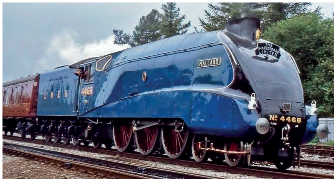
Lokomotiva Mallard je razvila malenkostno višjo hitrost od nemške 05 002, vendar na progi v rahlem padcu, ob tem pa se ji je stali ležaj srednjega gonilnega droga, tako da je bila nesposobna za nadaljnjo vožnjo. Tudi podatki meritev so glede najvišje hitrosti nekoliko sporni in se ne morejo otresti suma, da so bili prirejani.
