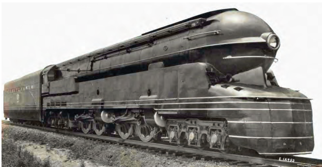
Lokomotiva S1, 'Big Engine', je bila unikat. Konstruktorji so pri razvoju zasledovali čisto nove, nenavadne ideje in rezultat je razočaral. Izdelali so samo ta primerek. Bila je tako obaltna in toga, da je lahko vozila samo po glavnih progah z ne preostriimi ovinki. Vendar je bila hitra, presneto hitra!
