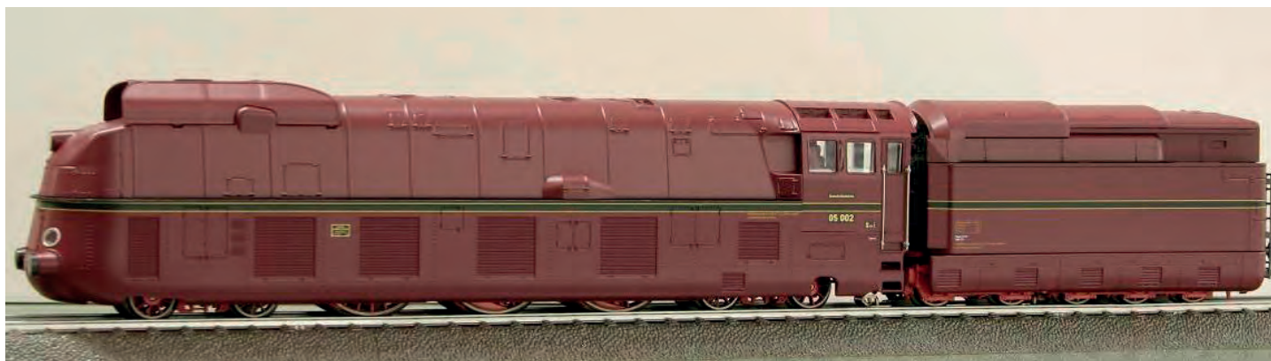
Tovarna Borsig je leta 1935 izdelala samo dve takšni orjaški lokomotivi, namenjeni za eksprese med Berlinom in Hamburgom. Njena pogonska kolesa so imela premer 2300 mm, na rekordni vožnji pa je dvojka razvila indicirano moč 3400 KM, točno dvakrat toliko kot naša velikanka 06 (!)
