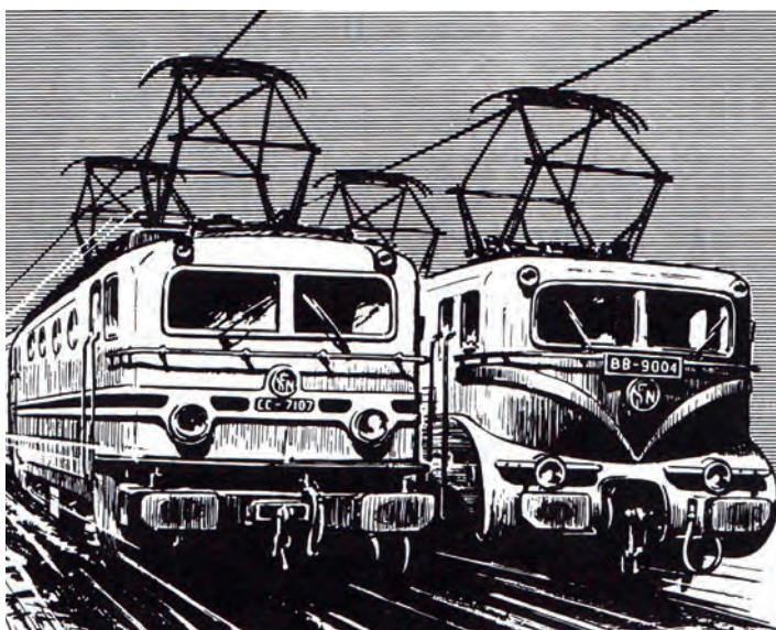
Francoški električni lokomotivi – šestosna CC 7107 in štiriosna BB 9004 – sta leta 1955 dokazali, da sta glede vedenja na tiru in moči enakopravni in da so Francozi trenutno vodilna železniška velesila. Seveda so se francoske železnice SNCF potem rade malo postavljale s tole ilustracijo ...
