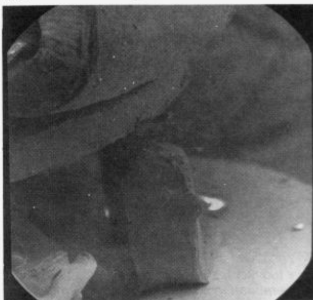
Slika 3. SR-1-24V po testu mehanske vzdržljivosti, ovira in kotva deformirani, povečava 470 ×.
