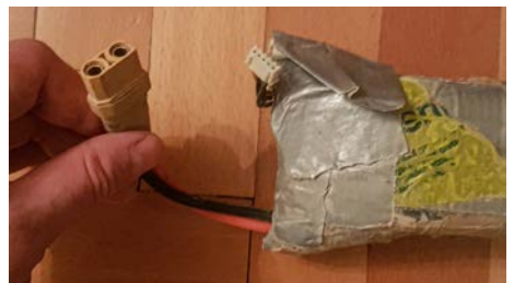
Slika 4: Baterija, ki se lahko priklopi na Malo vrtalko.
