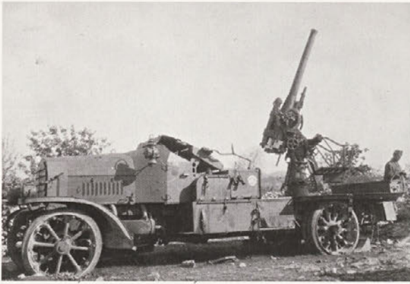
Premični 8-centimetrski protiletalski top sistema Ehrhardt na soški fronti. (Pokrajinski arhiv Nova Gorica, fototeka, album 203-1, 38.)
