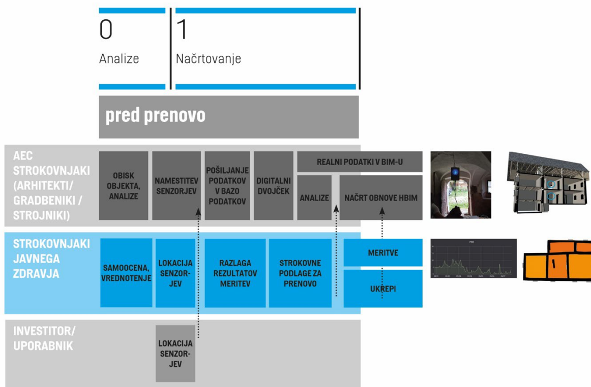
Slika 4: Sodelovanje različnih deležnikov: ukrepi potrebni pred prenovo stavbe (levo), senzorji ter rezultati meritev radona (desno)
