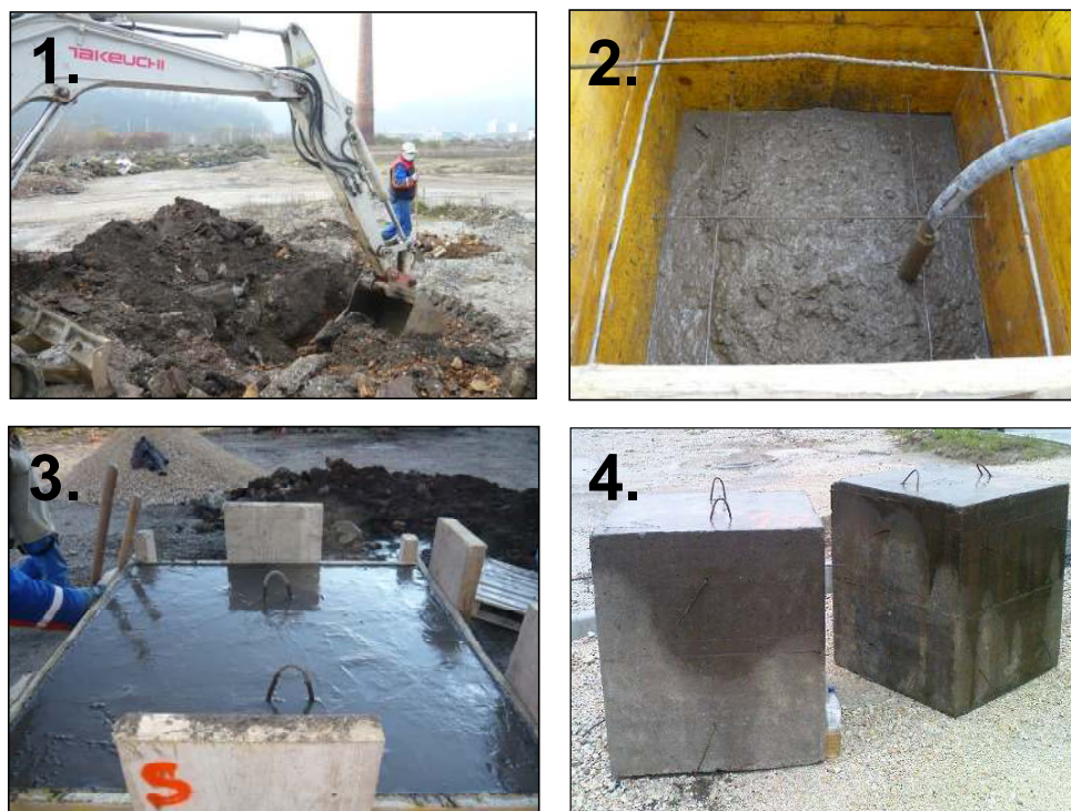
Slika 67: Pilotni poskus S/S onesnažene zemljine s cementom. Izkop (1), mešanje zemljine s cementom (2), vlivanje S/S zemljine v kalup (3), monolita stabilizirane zemljine (4). Foto: G. E. Voglar.
