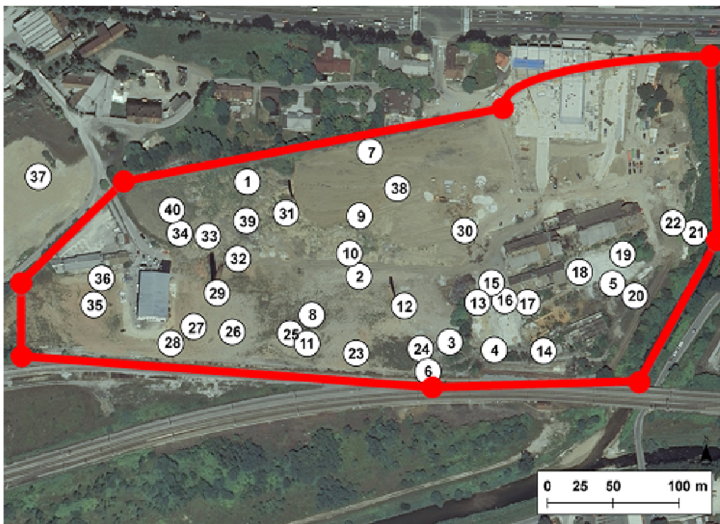
Slika 54: Vzorčna mesta (1-40) na območju Stare Cinkarne v Celju. Nakazana je hidrološka izolacija območja s permanentnimi pregradami proti vtoku in iztoku podtalnice in meteornih voda ter vertikalni jaški za stalen nadzor in ukrepanje.
