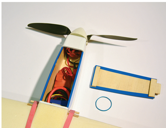
Pod pokrovom kabine je prost dostop do akumulatorja in za hitro menjavo.
