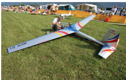
Jadralno letalo blantik je opremljeno z reaktivnim motorjem, ki mu omogoča vzletanje s steze in pridobitev višine, s katere nato leti kot klasično jadralno letalo.
