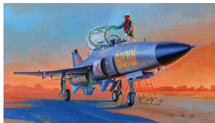
Kitajski lovec JL-9 v merilu 1 : 72 je zadnja izvedenka iz osnovne konstrukcijske rešitve MiGa-21, tokrat z bočnimi vstopniki zraka.
