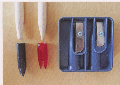
Slika 10. Ošiljene lesene paličice za puščice in dvojni šilček. Kota na strani konice in jahača sta različna.
