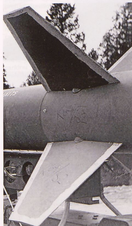
Pritrditev stabilizatorjev prve stopnje
