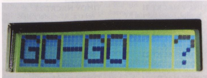
Primer LCD-izbire ukaza. Treba ga je le še potrditi in model lahko štarta, časovnik pa je pripravljen za odštevanje aktiviranja TEV. Čaka le še na vzlet modela, tj. odklop štartnega kabla.
