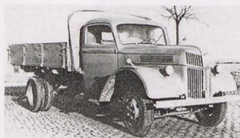
Tipična pozna izpeljanka z dodatnimi hladilnimi režami, poenostavljenimi blatniki spredaj in brez blatnikov zadaj.
