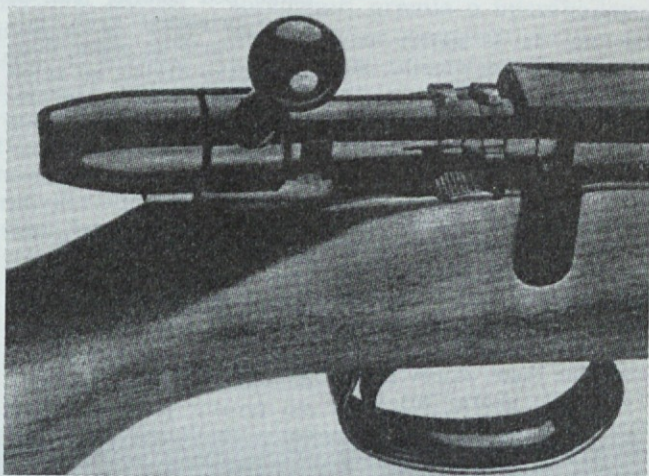
Slika 2. Valjasti zaklep z 8 varovalnimi čepi za naboj 5 mm RMR
