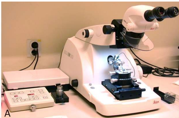
Slika 21: A) Ultramikrotom je naprava za rezanje poltankih in ultratankih rezin. B) Diamantni nož in Eponski blok s koščkom tkiva sta vpeta v ultramikrotom.
