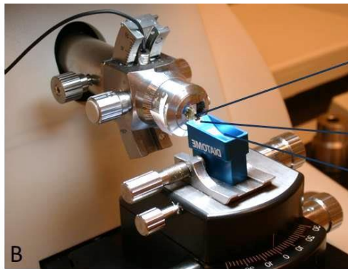
Slika 21: A) Ultramikrotom je naprava za rezanje poltankih in ultratankih rezin. B) Diamantni nož in Eponski blok s koščkom tkiva sta vpeta v ultramikrotom.
