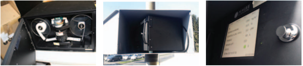
Slika 2: Instrument za merjenje črnega ogljika etalometer® Model AE33. Na levi je merilnik s trakom, na katerem so preiskovani vzorci delcev, v sredini je naprava, vgrajena ob križišču, na desni pa so zabeležene trenutne vrednosti onesnaženja.
