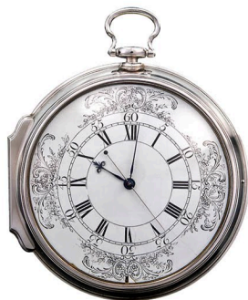
Slika 6.6 Kronometer – ura s sučnim nihalom na polžasto vzmet. Prikazana je replika prvega uporabnega kronometra za morska potovanja, ki ga je izdelal J. Harrison. Natančen je bil na minuto v letu dni. (Royal Observatory, Greenwich)
