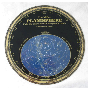
Slika 6.8 Vrtljiva zvezdna karta. Kaže položaj zvezd ob vsaki uri na vsak dan v letu. Nebesni poldnevnik (lege z enako rektascenzijo) so narisani kot premice in nebesni vzporedniki (lege z enako deklinacijo) kot krogi. Črni zaslon z ovalnim oknom in z vrisanimi urami je vrtljiv preko zvezdnega ozadja z vrisanimi dnevi. (Celestial Products)
