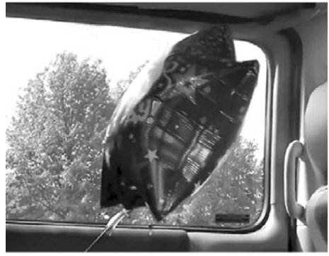
Slika 1: Odklon balona pri pospešenem gibanju avtomobila proti desni [3]. a) Balon, napolnjen z zrakom. b) Balon, napolnjen s helijem.
