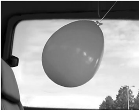
Slika 1: Odklon balona pri pospešenem gibanju avtomobila proti desni [3]. a) Balon, napolnjen z zrakom. b) Balon, napolnjen s helijem.
