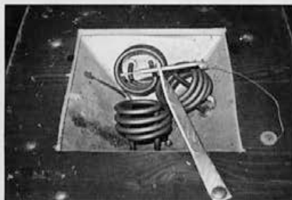
Nad motorjem so pritrjeni trije 150 W grelci, ki grejejo zrak za sušenje sadja, zelišč in cvetnega prahu.
