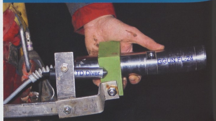
Slika 2: Terenski fluorimeter GGUN FL 24 in TD Diver, merilnik in beležnik temperature in vodnega nivoja.
