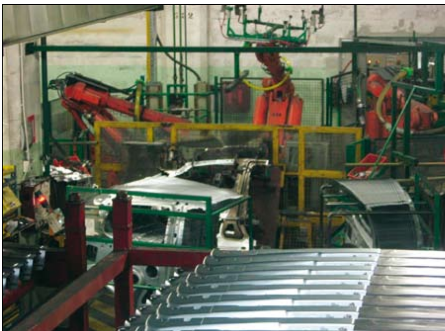
Slika 3. Robotska celica z dodanim tretjim robotom s prijemalom za prenos kosov
