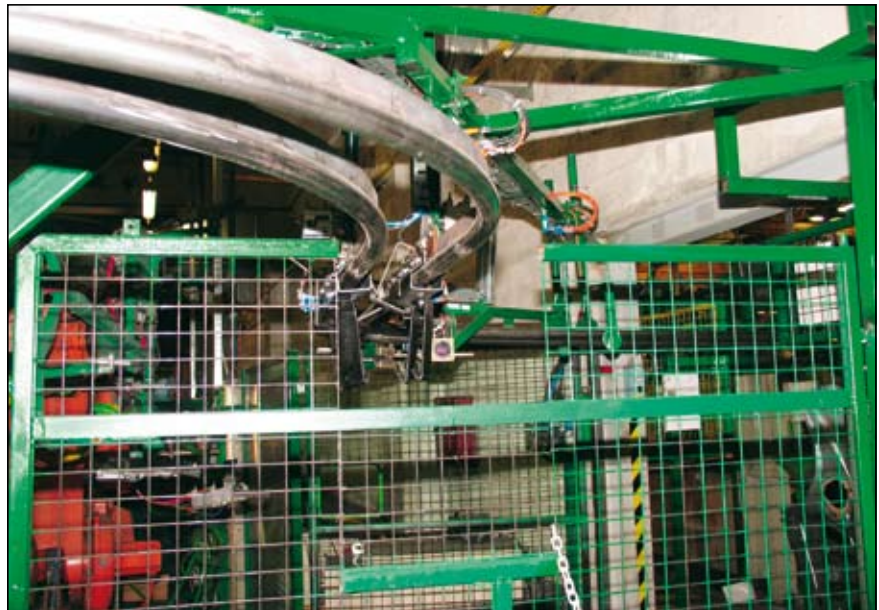
Slika 5. Sistem za fiksiranje vozičkov za obešanje kosov na gravitacijsko drčo
