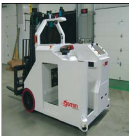
Slika 3. AGV z laserskimi skenerji za navigacijo in zaznavanje ovir
