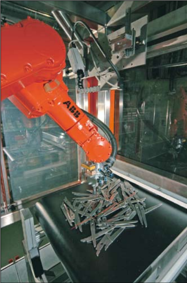
Slika 16. Določanje 3D položaja predmetov pri pobiranju
