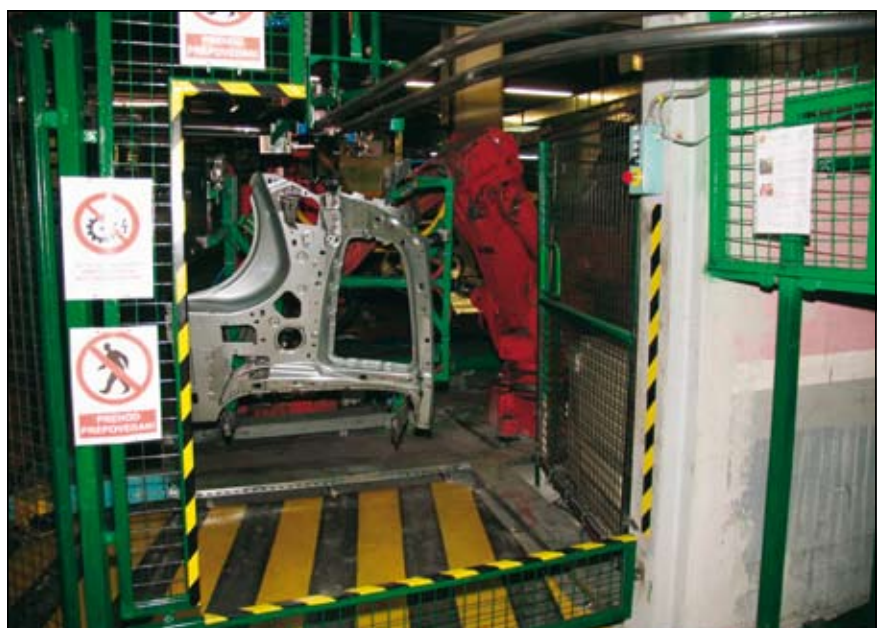
Slika 2. Pogled na delovno mesto robotske varilne celice za predsestavo notranjih oblog stranice karoserije OP 40 s strani izstopa kosov
