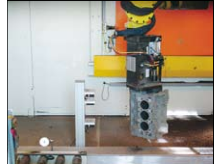
Slika 8. Preverjanje odlitka s senzorjem OD Precision s tremi merilnimi glavami
