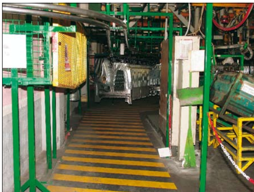
Slika 4. Pogled na del drče proti OP 60 z vidno varnostno zalogo
