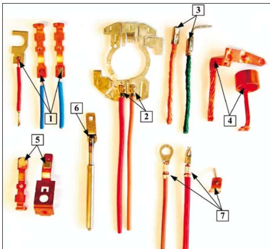
Slika 1. Prikaz nekaterih električnih elementov, ki so spojeni z različnimi postopki: 1 – lasersko varjeni spoji, 2 – elektroporovno zvarjeni žici z drugim elementom, 3 – elementi, spojeni s hibridnim postopkom (kompaktiranje), 4 – ultrazvočno zvarjena elementa, 5 – ploščici, ki sta spajkani z električno upornovno energijo, 6 – spoj, izdelan z elektroporovnim varjenjem, 7 – zvarjeni spoji, izdelani z mehansko energijo
