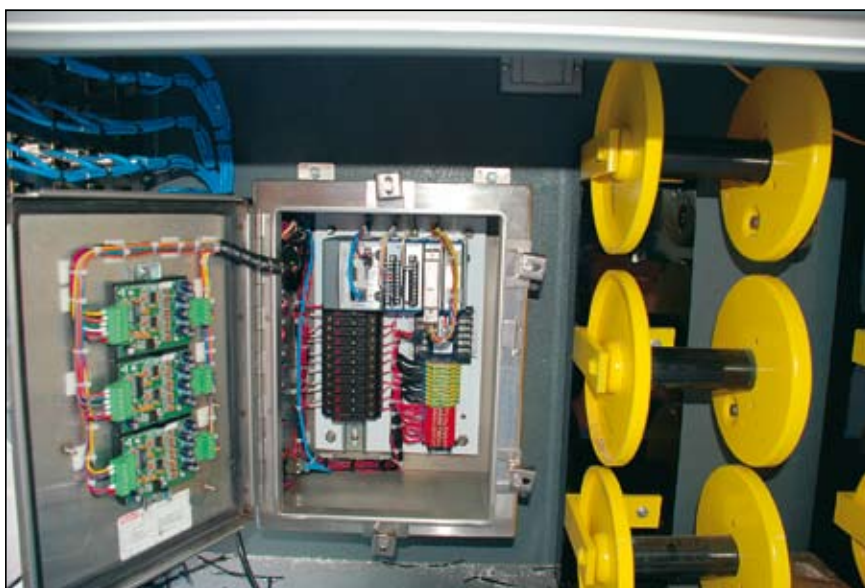
Napredni nadzorni sistem osnovan na platformi CompactRIO, ki je lahko nameščen direktno na črpalko naftnega črpališča v industrijskem okolju
