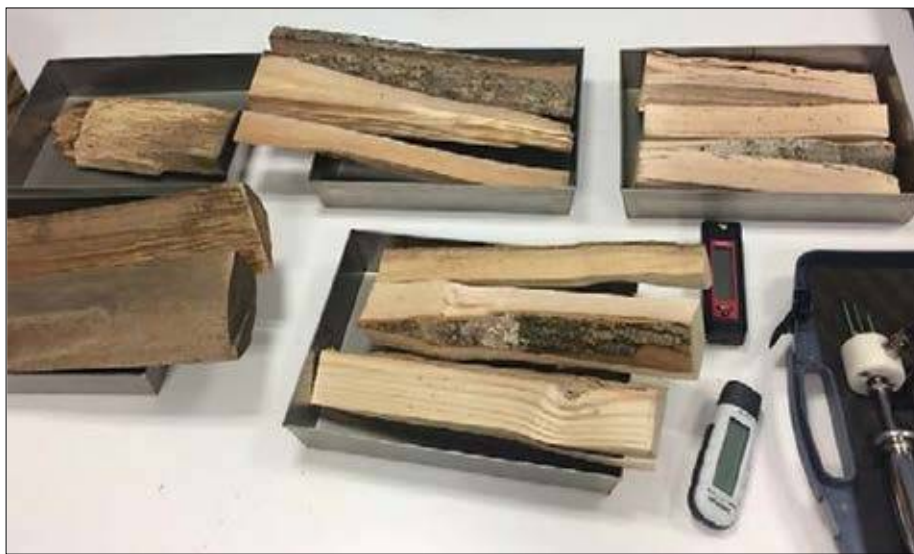
Slika 1: Drva /polena smo tik pred meritvijo razcepili na tri/štiri približno enako velike kose, ter meritve najprej opravili z elektro-uporovnimi merilniki na vsaj štirih različnih mestih. Takoj za tem smo vzorce stehali ter jih posušili, kot predpisuje metoda za gravimetrično določanje vlage.
