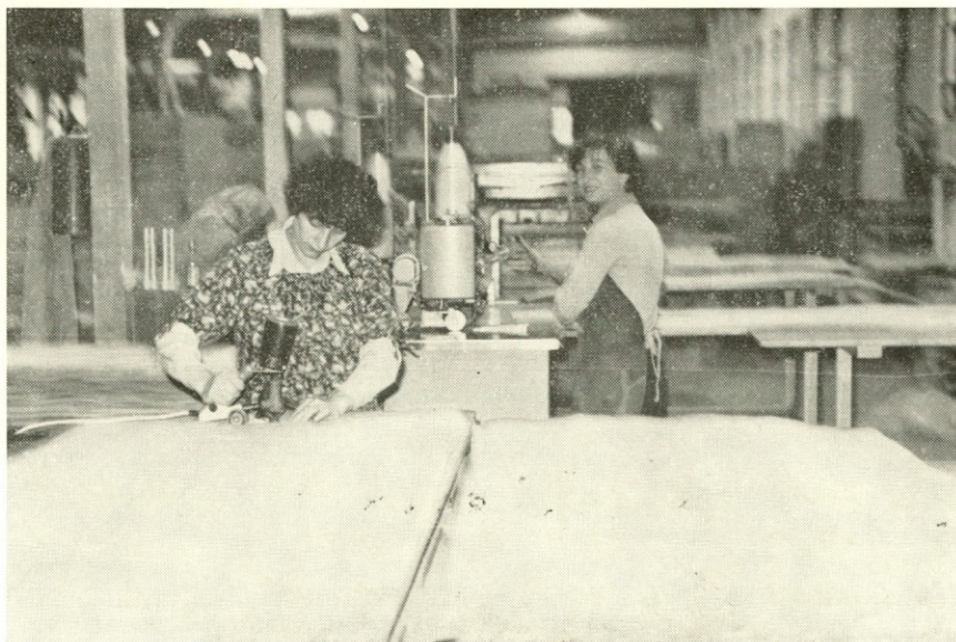
Popravljanje furnirja na konceh v vratarni v Borovnici
