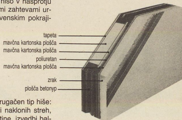
Prezrez zunanje stene montažne hiše s fasado
