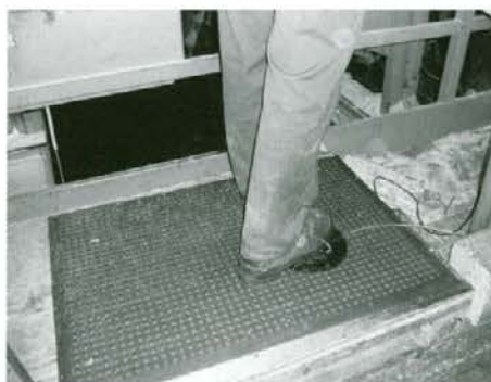
Izvajanje meritev vibracij na delovnem mestu robilničar
