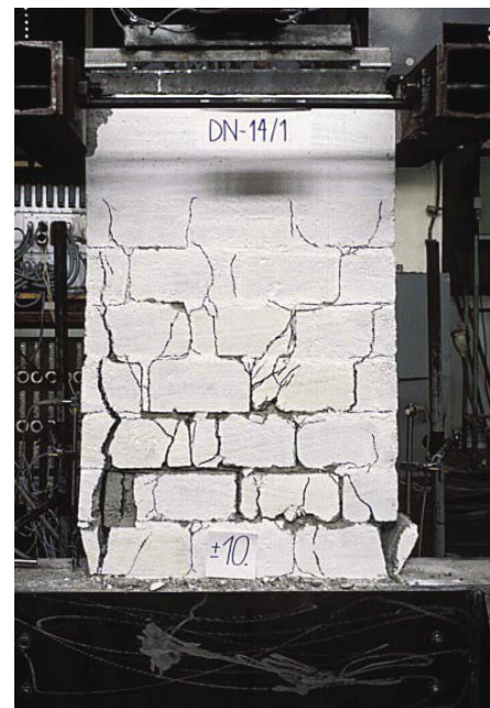
Slika 29 • Duktilna strižna porušitev nizkega zidu, armiranega z navpično armaturo po robovih in vodoravno armaturo v naležnih regah (Fotografija: M. Tomaževič)
