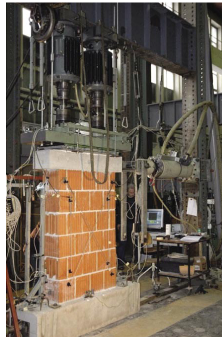
Slika 6 • Preiskava zidu iz opečnih votlakov kot navpične konzole (Fotografija: Arhiv ZAG)
