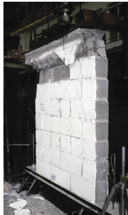
Slika 34 • Krhka porušitev celotne vrste betonskih votlakov že na začetku preiskave zidu z močno upogibno armaturo in armaturo v žlebovih naležnih reg (Fotografija: M. Tomažević)
