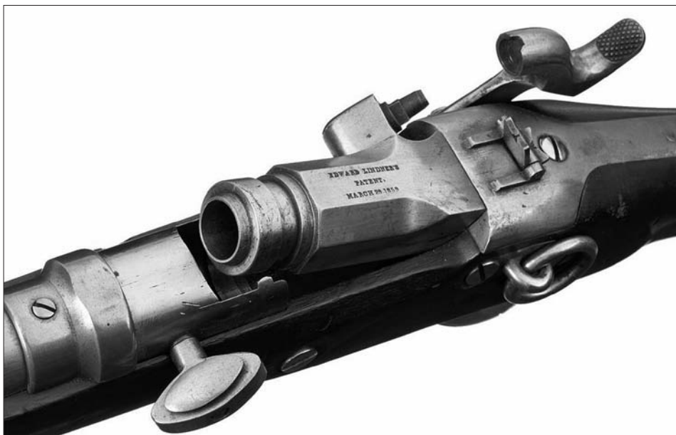
Lindnerjev patent iz leta 1859: puška s preklopno komoro (© www.icollector.com).
