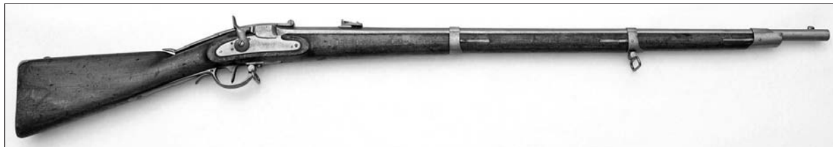
Puška M 1854 tipa Lorenz, leta 1860 predelana na zadnje polnjenje z enovitim nabojem po patentu Edmunda Pistotnika (NMS, inv. št. N 36902, foto: Tomaž Lazar).
