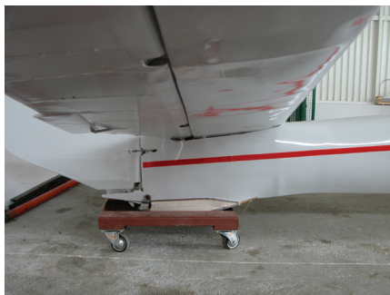
Detajl konca trupa s pritrditvijo višinskega in smernega stabilizatorja ter pogled na zadnjo smučko
