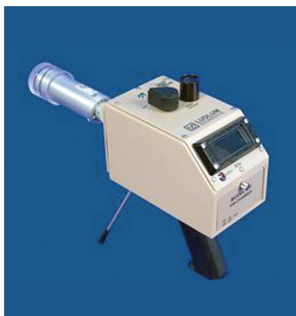
Ionizacijska celica »Cutepie«
