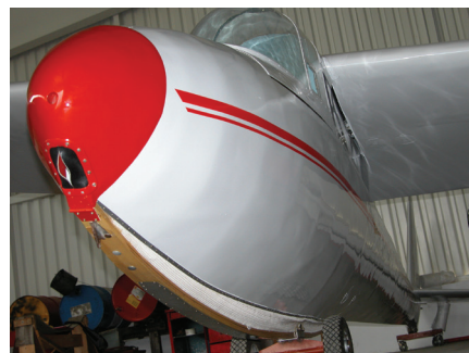
Detajl nosu letala. Lepo se vidita značilen, ostro zaključen spodnji del trupa in detajl smučke.
