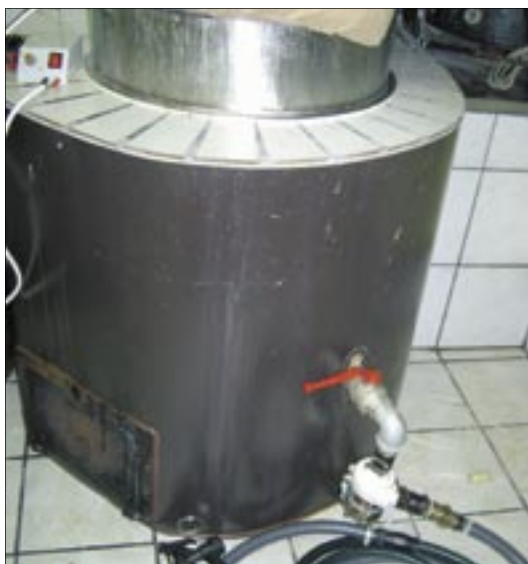
Kotel s pipo za dotok sveže vode
