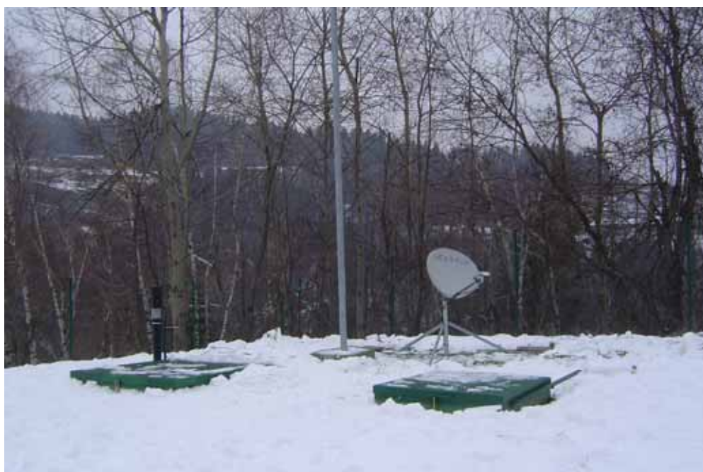
Slika 3. Nova potresna opazovalnica na Črnem Vrh nad Polhovim Gradcem (CRNS) z začasno postavljeno satelitsko anteno za prenos podatkov po satelitskem internetu. Figure 3. New seismic station on Črni Vrh above Polhov Gradec (CRNS) with temporary installed satellite antenna for data transmission over satellite internet.
