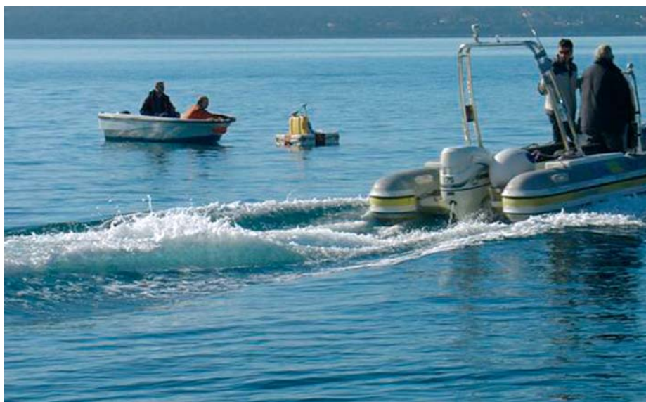
Slika 2 • Povzročanje valov z motornim čolnom in merjenje višine valov
