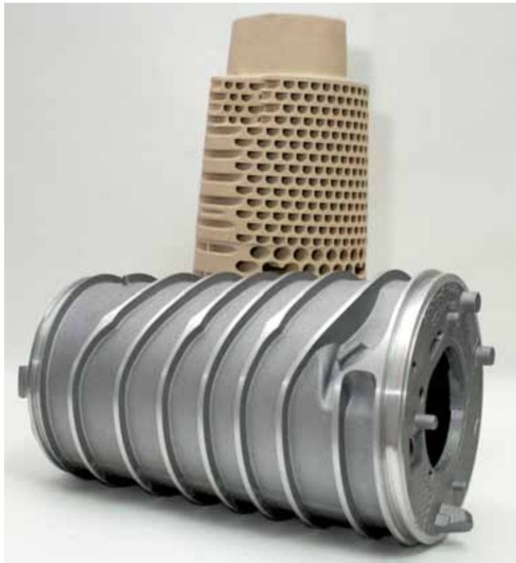
CNC-obdelan toplotni izmenjevalnik WB6, kupec je Bosch Thermotechnic.
