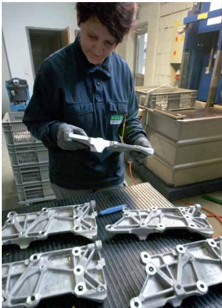
Marinka Krajnc, procesna kontrolorka pri pregledu nosilca motorja Macan Porsche
