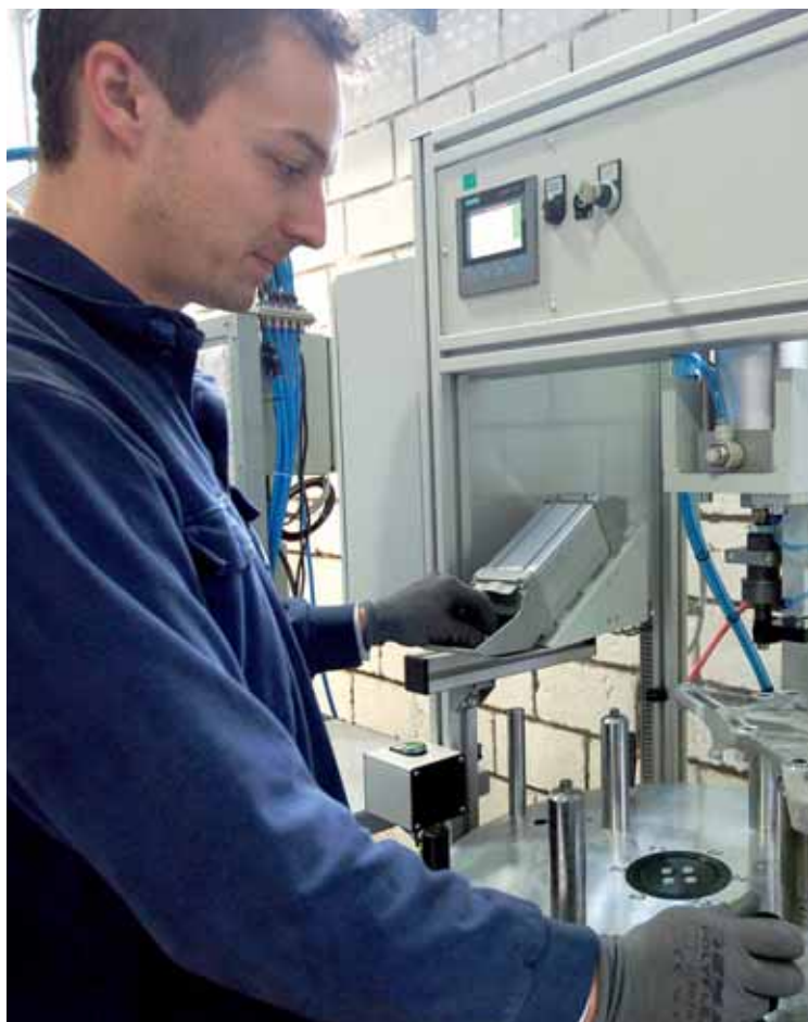
Boštjan Butolen vtiskuje puše na CNC-obdelani konzoli motorja Macan Porsche.
