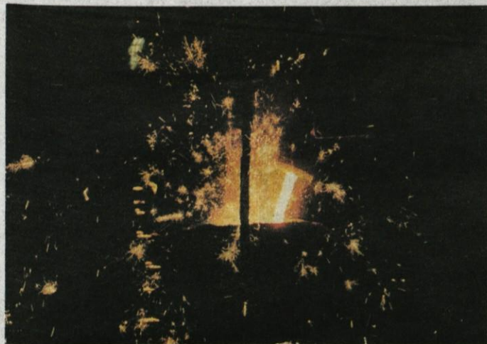
Lep je prizor, ko se litina iz peči vlije v lonec in iz njega v model, vendar je ročno vlivanje zelo naporno delo.
