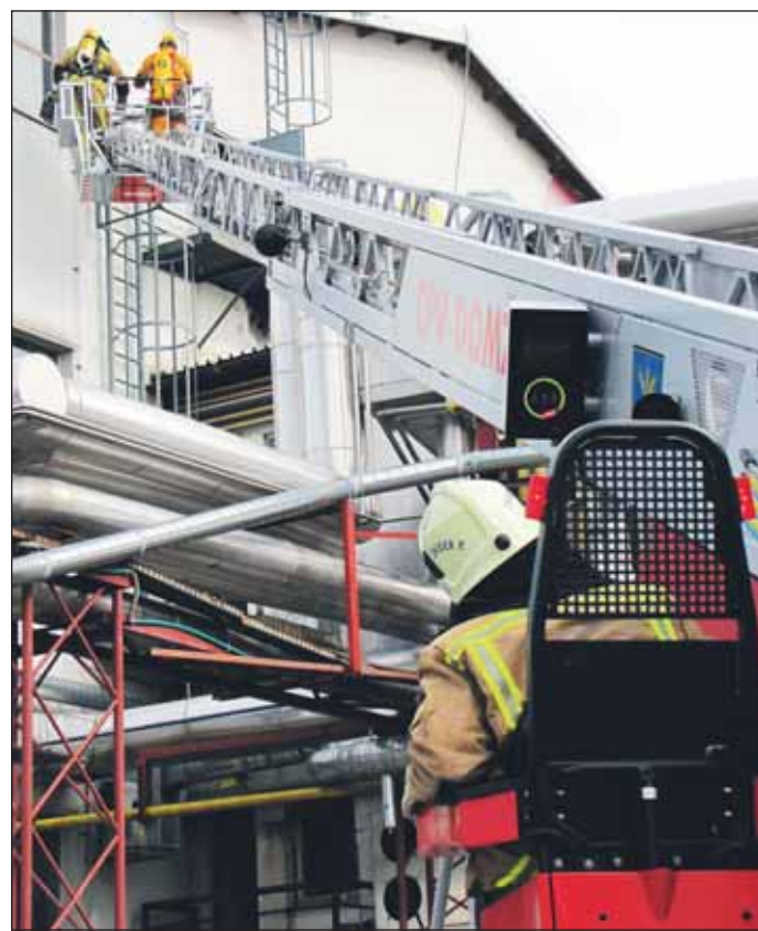
Gasilska motorna lestev zagotavlja varnejšo in hitrejšo intervencijo.
