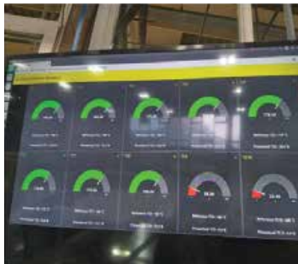
Spremljanje delovanja ekstruzijske linije preko vgrajenih senzorjev.
